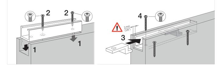
8 COLOCACIÓN DEL GUIADOR / GUIDE INSTALL
