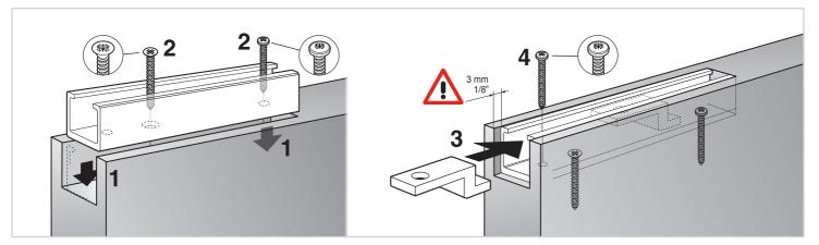
6 COLOCACIÓN DEL GUIADOR / GUIDE INSTALL
