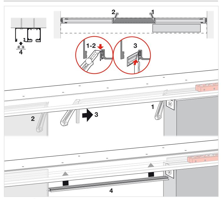
18 COLOCACIÓN DEL TAPABOCAS DEL CANAL DE PUERTA CORREDERA COVER FOR UPPER SLIDING DOOR CHANNEL
