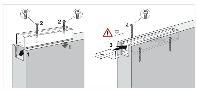
12 COLOCACIÓN DEL GUIADOR / **GUIDE INSTALL**
