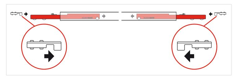
8 MONTAJE DEL PERFIL PARA INSTALACIÓN VISTA UPPER TRACK MOUNTING POR EXPOSED INSTALLATION
